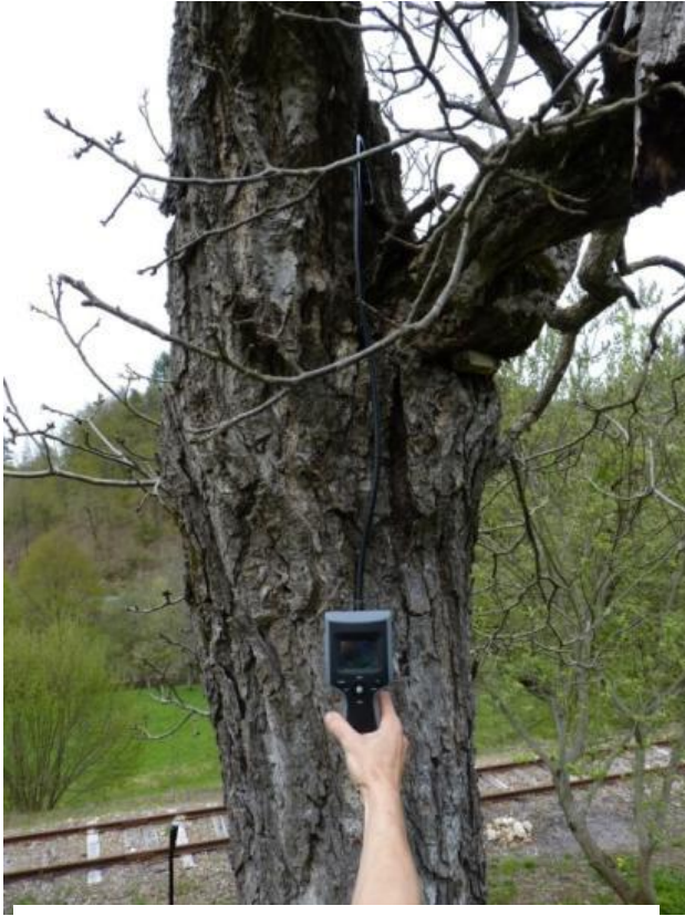
Figure 3 : Un endoscope en action. L'écran permet de visualiser l'intérieur de la cavité via la caméra, qui se trouve au bout du câble noir articulé.
